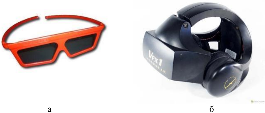
Рис. 14.1. Технічні засоби створення віртуального оточення: а – D окуляри для перегляду стереоскопічних зображень; б – шолом віртуальної реальності.
