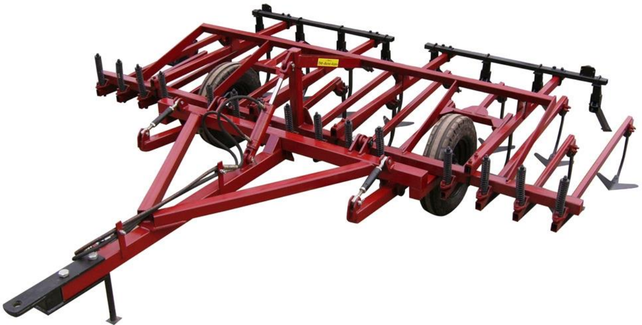
Рис. 1. Загальний вигляд парових культиваторів для суцільного обробітку ґрунту КПСП-4 з різними схемами розташування натискних пружин
