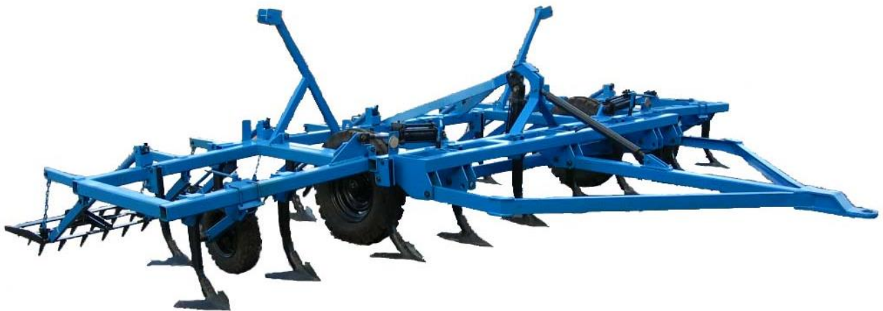
Рис. 2. Загальний вигляд секційного культиватора КПМ-6
