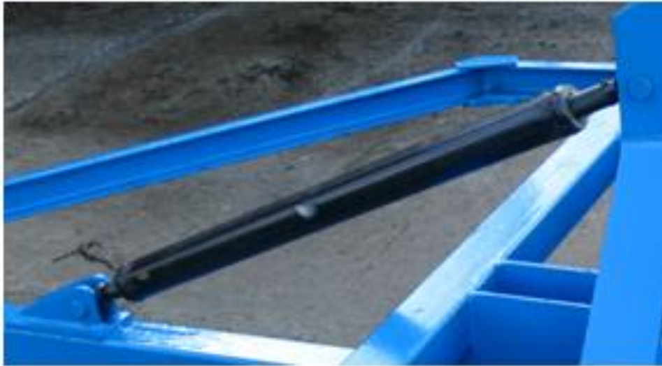
Рис. 9. Гвинтова телескопічна тяга
