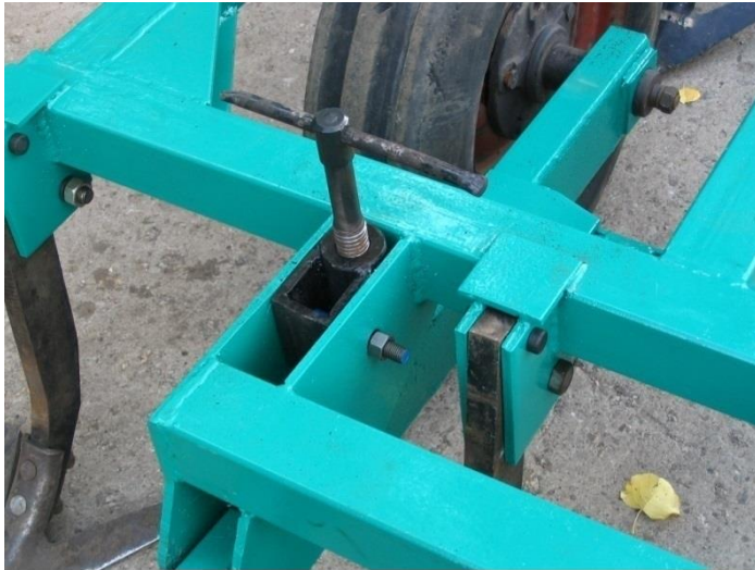
Рис. 8. Механізм регулювання глибини обробітку: а – гвинтовий механізм центральної секції; б – опорне колесо бокової секції
