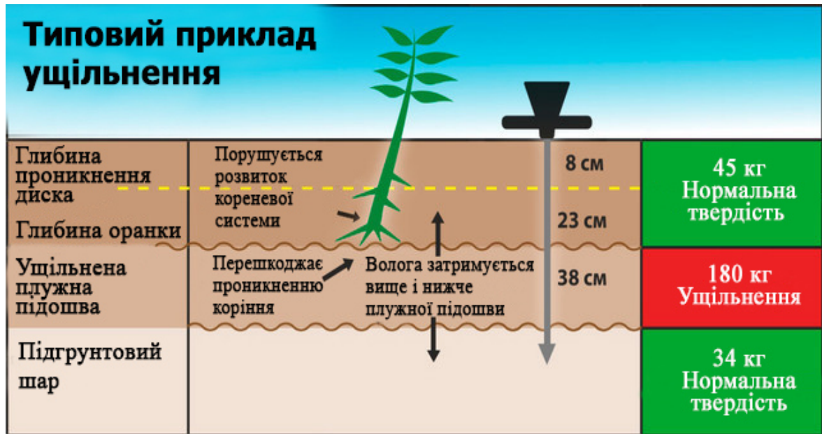
Рис. 2.5. Типовий приклад ущільнення ґрунту
