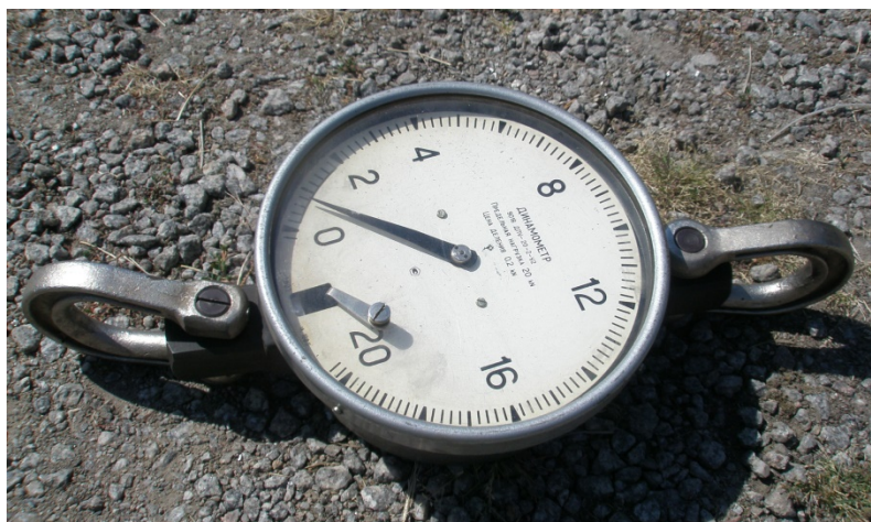
Рис. 2.13. Механічний пружинний динамометр типу ДПУ, що використовується для вимірювання тягового опору сільськогосподарських машин
