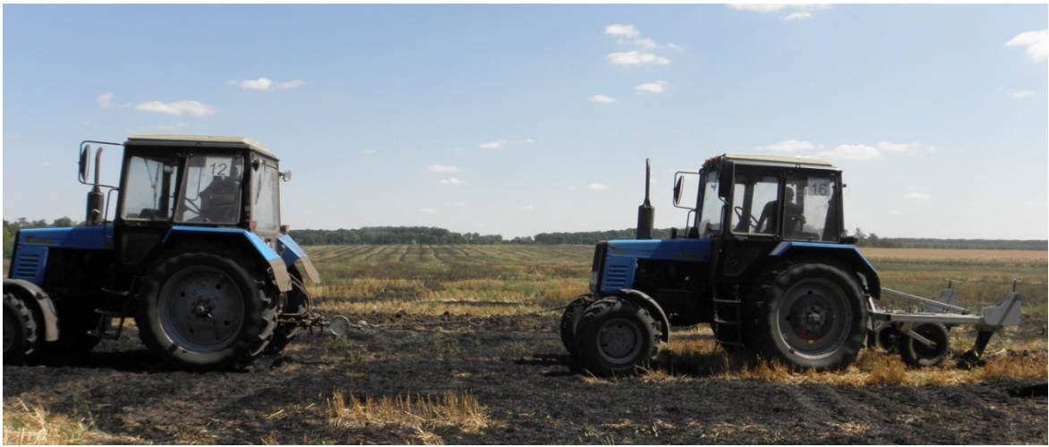
Рис. 2.14. Зчіпка тракторів під час вимірювання тягового опору машини
