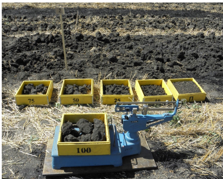
Рис. 2.20. Решітний класифікатор для визначення коефіцієнту кришення ґрунту
