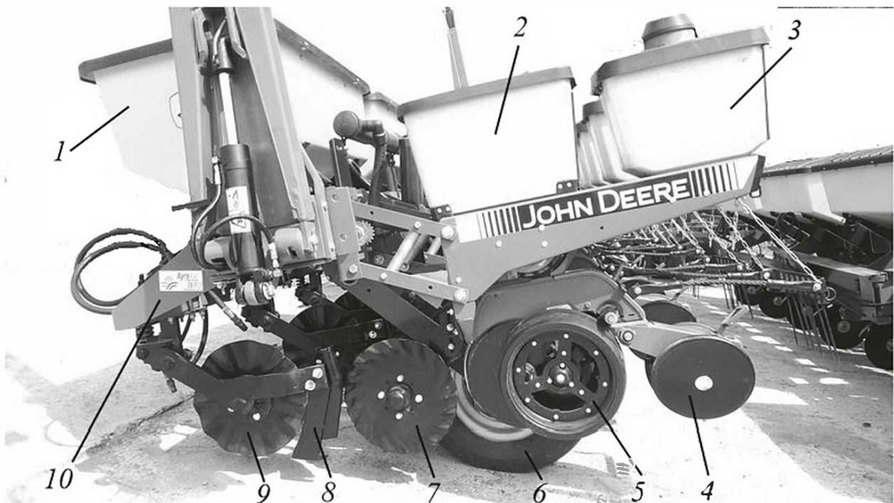
Рис.3.17. Просапна сівалка точної сівби для технології No-Till:
