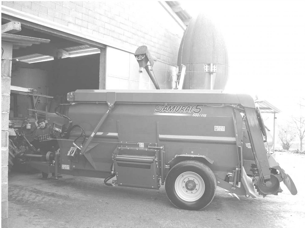
Рис. 5.16 Причіпний фермський комбайн SAMURAI 5 фірми Seko (Італія) з двома горизонтальними змішувальними шнеками та завантажувальною фрезою
