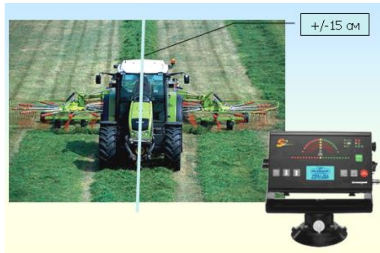
Рис. 2. Загальна схема функціонування системи паралельного водіння МТА.
