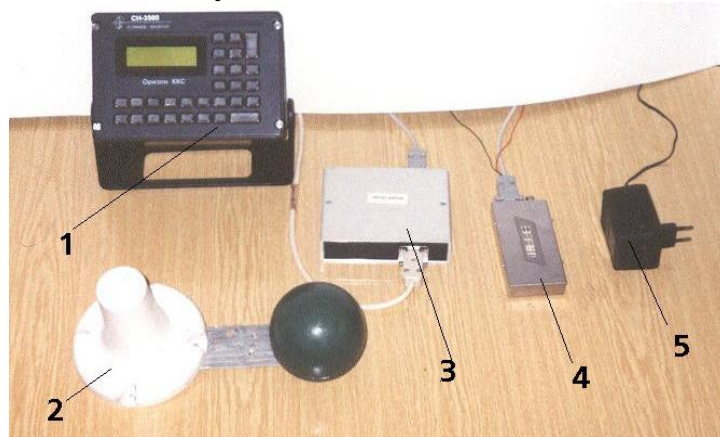
Рис. 3. Станція диференціального сигналу СН-3500
